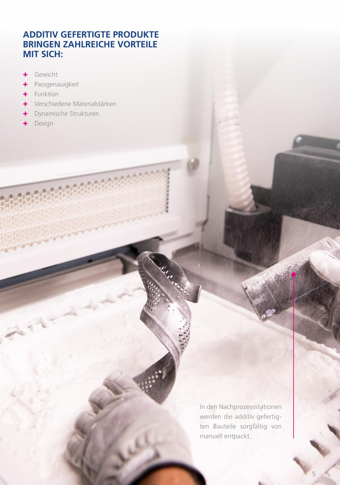
In den Nachprozessstationen werden die additiv gefertigten Bauteile sorgfältig von manuell entpackt.
